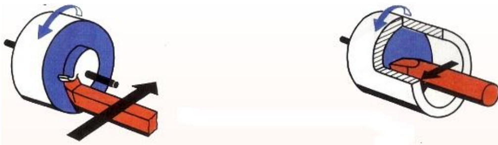
Fig. 11. Esquema funcional de refrentado
