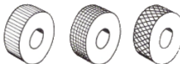
Fig. 20 Tipos de Moleteados (Paralelo, en cruz y en X)
