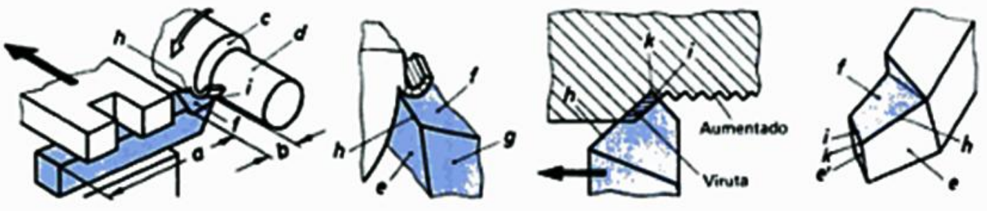
Fig. 28. Superficies de una cuchilla
