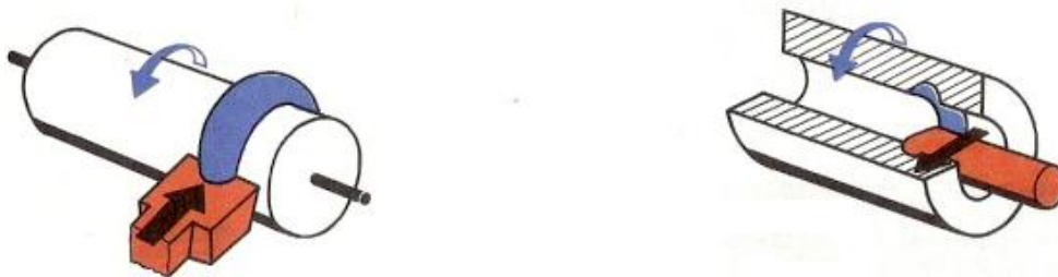
Fig. 16. Torneado de piezas con forma
