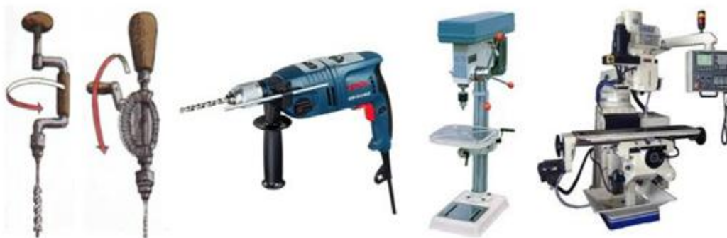
Fig. 1 Evolución de las Máquinas Taladradoras
